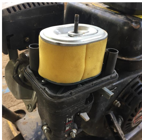
Figura 3.7 Tuerca mariposa que sujeta el filtro
