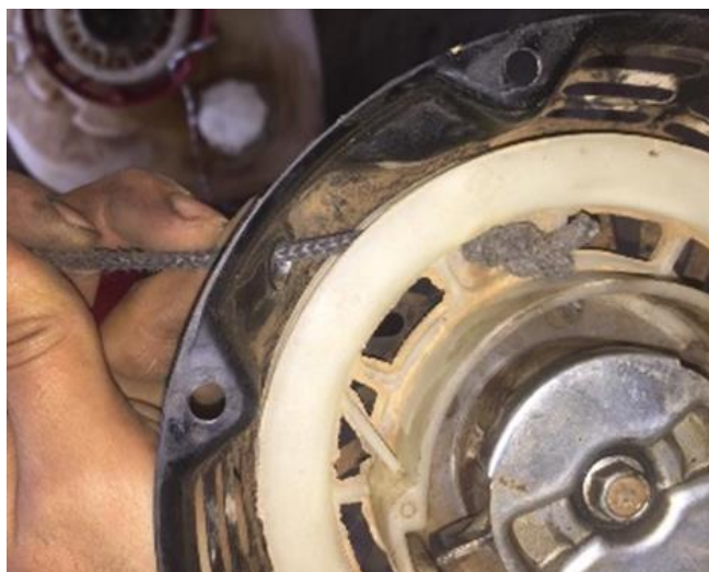
Figura 3.23 Instalación de cuerda
