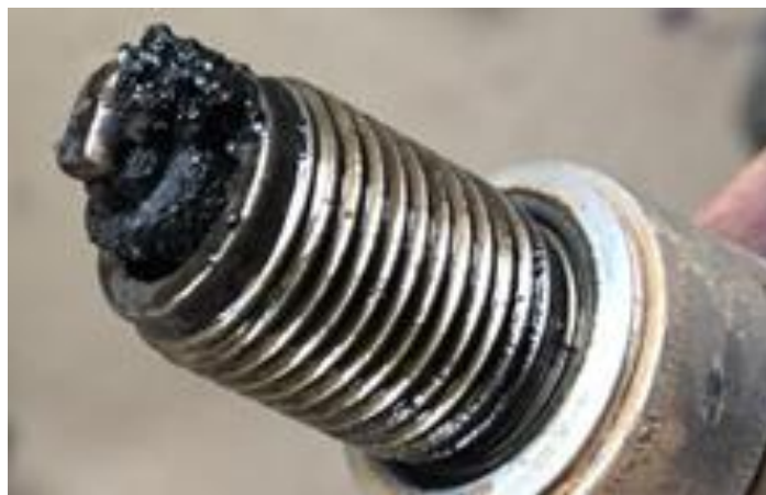
Figura 3.12 Bujía en malas condiciones
