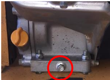
Figura 3.26 Perno para drenar el aceite
