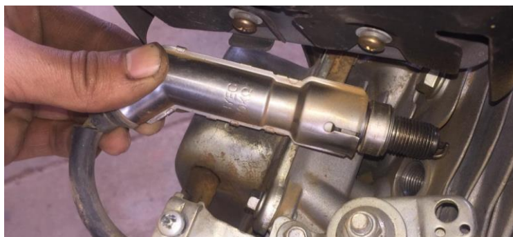
Figura 3.17 Como probar la bujía
