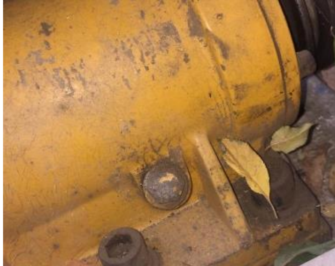
Figura 3.35 Perno de nivel de aceite
