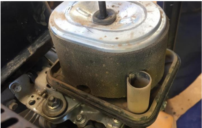
Figura 1.16 Filtro de aire sucio
