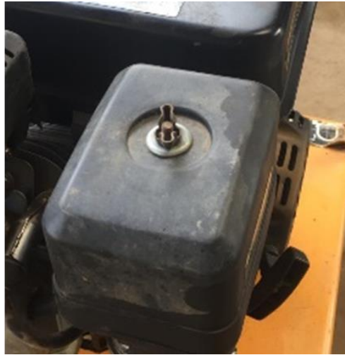
Figura 3.6 Tuerca mariposa que sujeta la tapa del filtro
