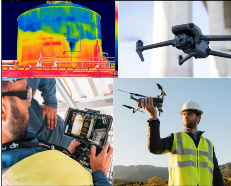
Figura 13: Termografía Infrarroja Obtenida con la Utilización de Drones.
