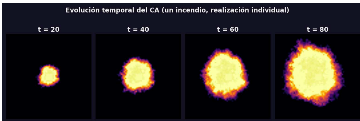
Figura 7: Progresión temporal del autómata celular Monte Carlo para un registro representativo. Cada panel corresponde a un horizonte temporal distinto, mostrando la expansión gradual del frente de fuego desde el punto de ignición central. Fuente: Elaboración propia.
