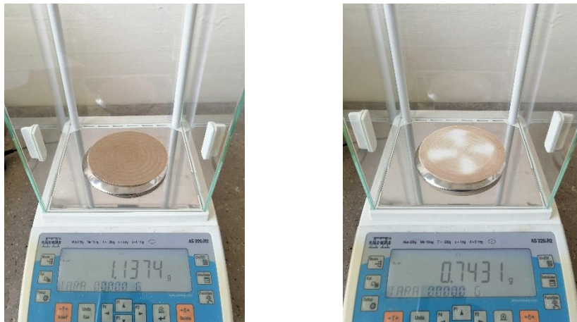
Figura 5.6. Pesaje filtros impactados
