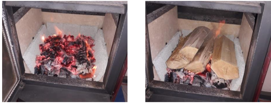
Figura 5.4. Lecho de brasas y carga de combustible para el pre ensayo
