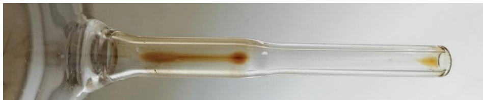
Figura 6.6. Condensación en las copas del portafiltros
