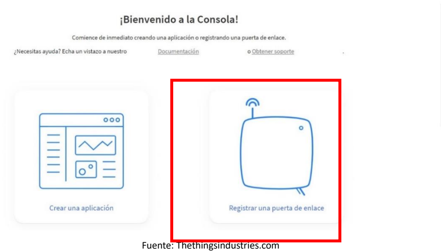
Figura 2-47 Primer paso para registrar una puerta de enlace
