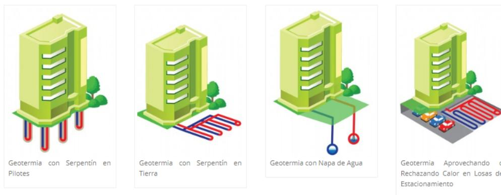
**Figura 4.20:** Tipos de instalaciones de Geotermia en edificios.
