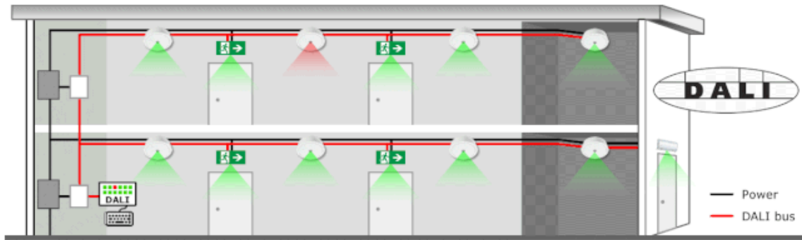
Figura 1.2, Arquitectura DALI, Fuente: https://www.upowertek.com/es/la-guia-definitiva-de-dali/
