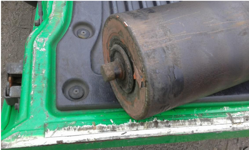
Figura 2- 2 Polin con eje suelto.
