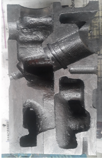
(a) Vista Izquierda: Cercana a válvula de Escape (b) Vista Derecha: Cercana a válvula de Admisión
