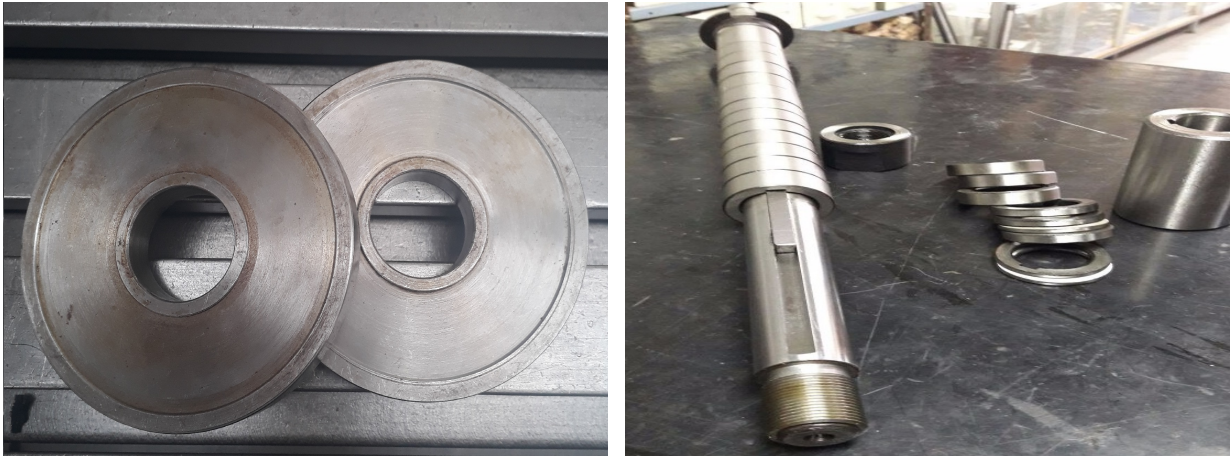
(a) Bujes en contacto con el disco
