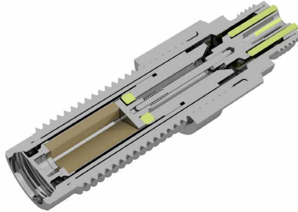
Figura 4.1: Estructura de sensor 6052C
