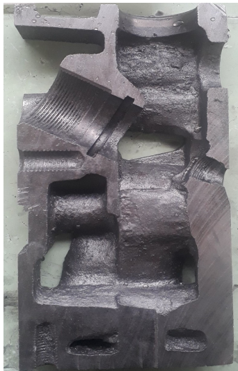
(a) Corte real 3: Cercano a válvula de admisión
