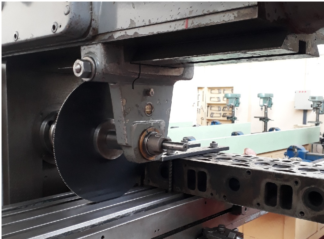
Figura 3.12: Montaje de Disco D751 y Culata OM366 LA en Fresa Milwaukee
