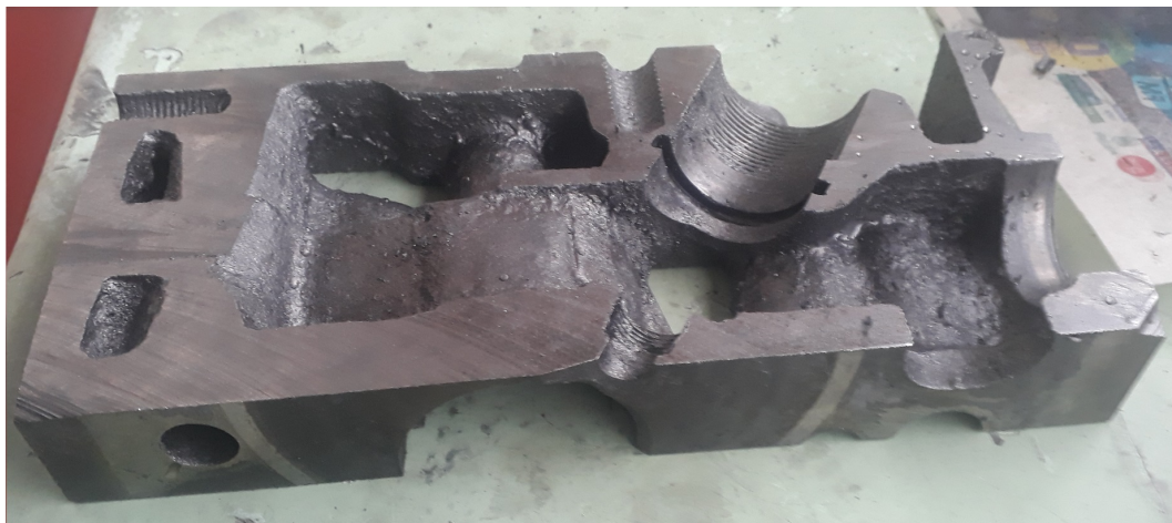
Figura 3.25: Visualización zona de instalación camisa 6525ASP
