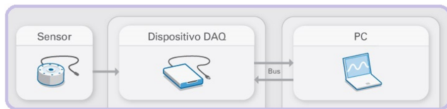
Figura 4.10: Sistema de Adquisición de Datos General Adaptada de National Instruments - ¿Qué es Adquisición de Datos?
