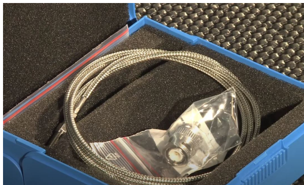
Figura 5.3: Conjunto 6052C39U20: Sensor, Cable M4 y Conector BNC.
