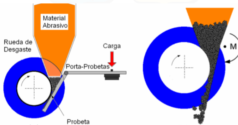
Figura 3.18: Comparativa entre el esquema de la máquina real y la simulación del ensayo de desgaste.
