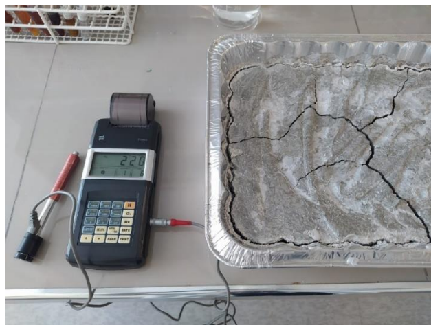
Figura 31: Medidor de dureza junto con muestra fabricada en laboratorio UTFSM.
