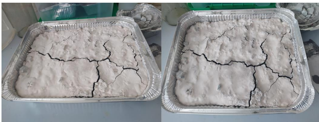
Figura 61: Prueba resistencia a la lluvia. Izquierda: Antes de la prueba. Derecha: Después de la prueba.
