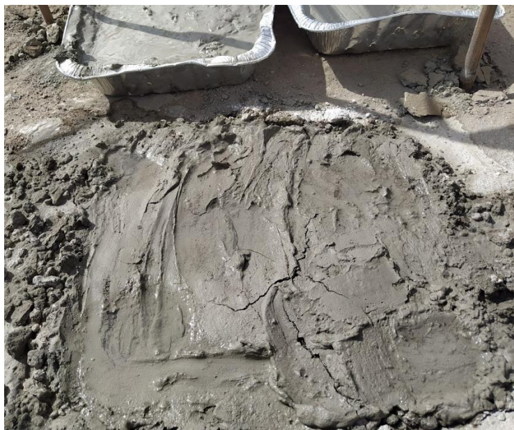
Figura 52: Ampliación de fractura producida en muestra in situ en los primeros 5 minutos de fraguado.
