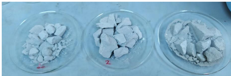
Figura 34: Muestras de geopolímero puestas a prueba en ensayo de humedad.
