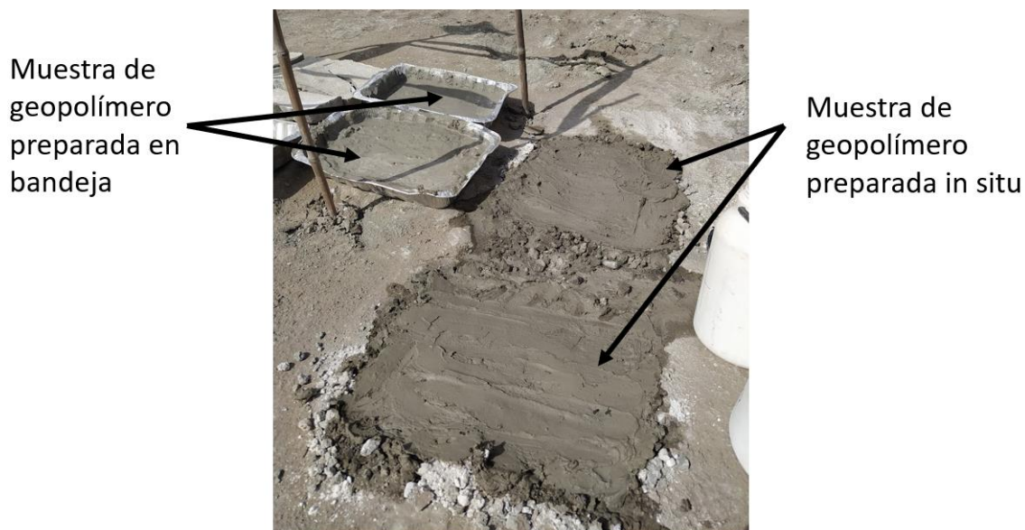
Figura 49: Muestras de geopolímero preparada en bandeja e in situ para observación de fraguado. Día 0.
