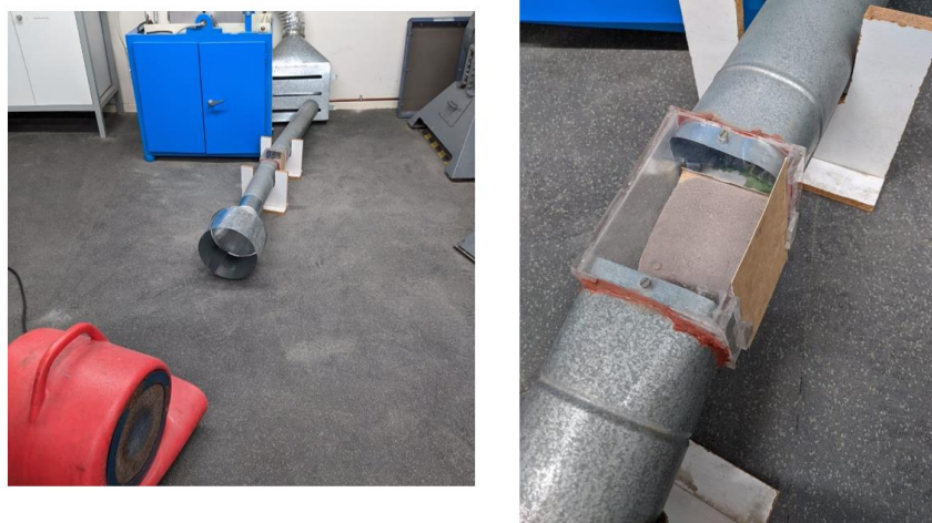
Figura 28: Túnel de viento en laboratorio y porta muestra.
