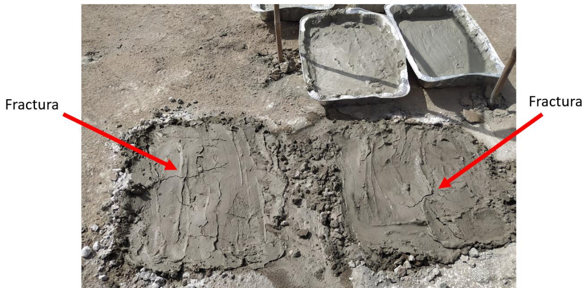
Figura 51: Agrietamiento producido en las muestras preparadas in situ al cabo de 5 minutos aproximadamente.
