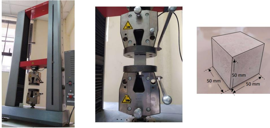
Figura 30: Máquina de tracción y una de las probetas fabricadas.
