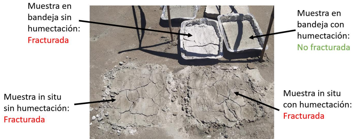
Figura 50: Estado de muestras preparadas para observación de fraguado y efecto de humectación después de 1 semana.
