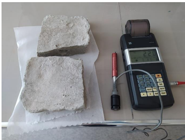
Figura 32: Medidor de dureza junto con algunas muestras de supresor de polvo geopolimérico fabricadas en la faena minera Cerro Negro.
