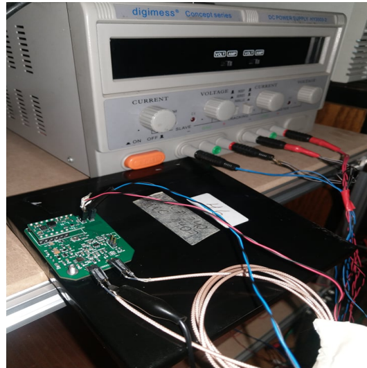
Figura 3.1: Estación de trabajo para el experimento de caracterización de la amplitud de los pulsos de MPPC.
