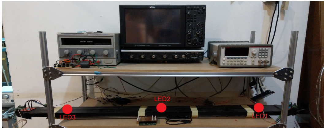
Figura 6.3: Fotografía de la estación de trabajo para las pruebas experimentales. Se aprecian los instrumentos utilizados, el detector centellador y la electrónica diseñada.
