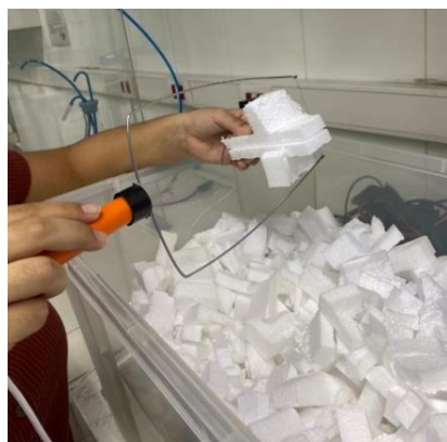
Figura 6. EPS fraccionado mediante corte por resistencia eléctrica.
