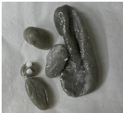
Figura 8. Densificación mecánica del EPS en el molino de impacto usado.
