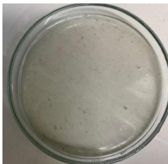
Figura 9. Película delgada obtenida de la mezcla de EPS/d-limoneno.
