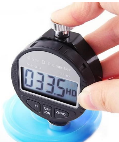
Figura 23. Posicionamiento del durómetro sobre un polímero en superficie plana [71].
