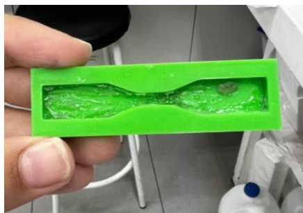
Figura 15. Molde inicial para probeta tipo IV según ASTM D638-22 en filamento TPU.
