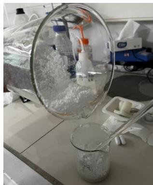
Figura 18. Incorporación gradual de EPS en la solución de d-limoneno con fotoiniciador.
