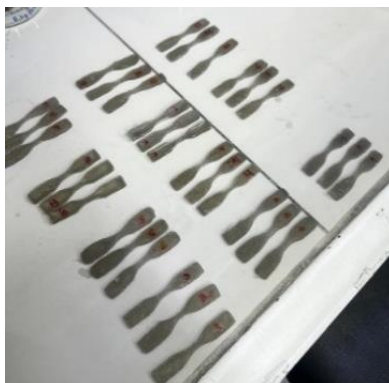
Figura 22. Set de probetas fabricadas según matriz de diseño experimental del software MODDE PRO-13.
