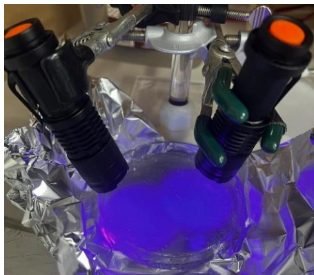
Figura 14. Ensayo de fotopolimerización bajo lámparas de irradiancia fluctuante.
