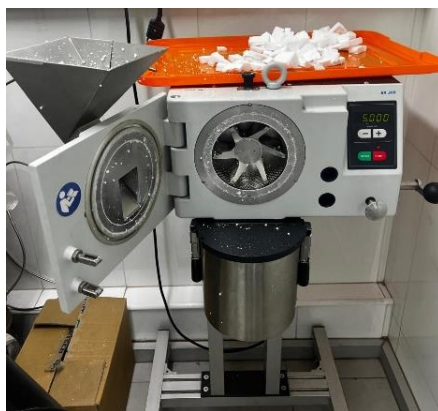
Figura 7. Molino de impacto de rotor utilizado en la trituración del EPS.
