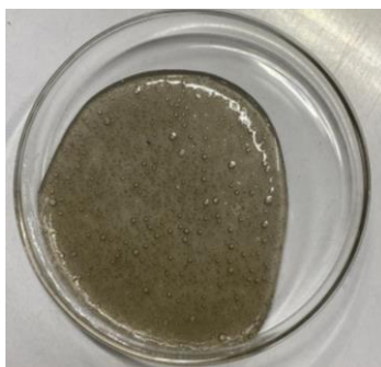
Figura 10. Evidencia de degradación térmica y nucleación de burbujas en mezcla sobresaturada.
