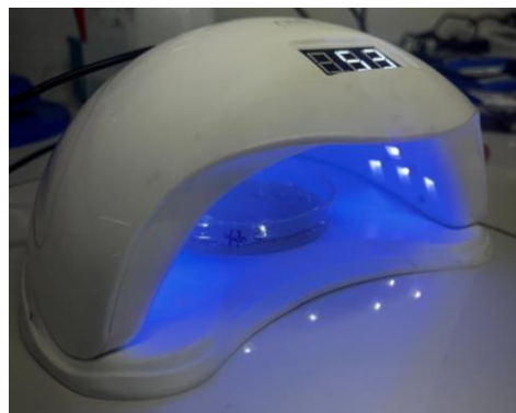
Figura 13. Ensayo de fotopolimerización mediante radiación UV de baja densidad.
