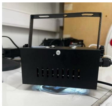
Figura 21. Disposición de lámpara UV para el curado del material en los moldes impresos en 3D.
