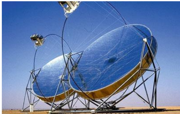
Figura 3-10. Instalación de PDC con 17 metros de diámetro [8].
