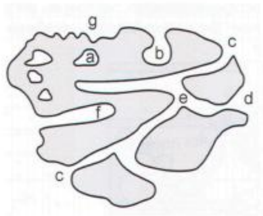
Figura 3-12. Estructura porosa. a) poro cerrado, b,c,d,e,f) poros abierto, b,f) poros sin salida g) rugosidad [54].
