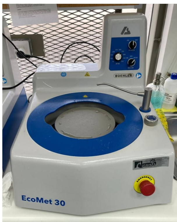
Figura 4-20. Pulidora semiautomática marca BUEHLER modelo ECOMET 30.
