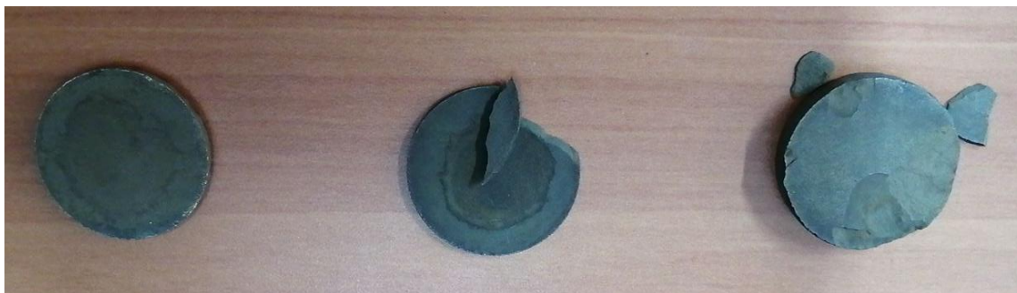
Figura 5-14. Muestra B2 cortada en láminas de 2-3mm.
