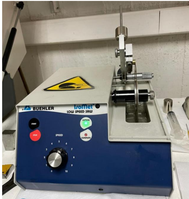
Figura 4-18. Seccionadora de precisión marca BUEHLER modelo IsoMet Low Speed, utilizada para el corte de muestras de 10 mm.
