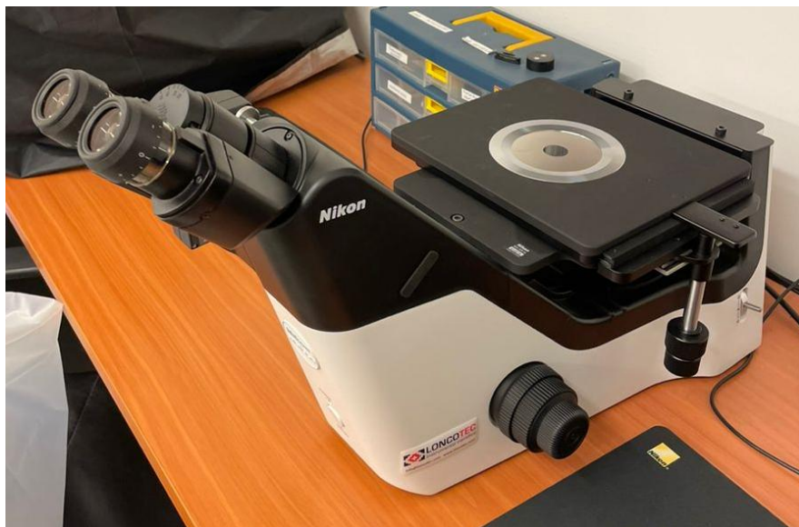
Figura 4-21. Microscopio invertido marca Nikon Modelo Eclipse LV100ND.
