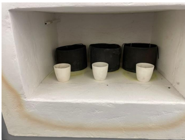
Figura 6-4. Crisoles con muestras enterradas en escoria de cobre dentro del horno.
