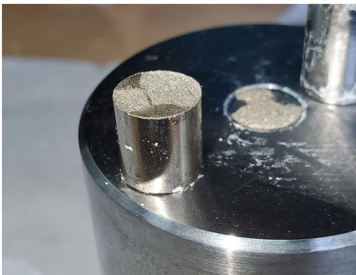
Figura 5-4. Pre-compactación de muestra A1 con polvos molidos a 1129 MPa.
