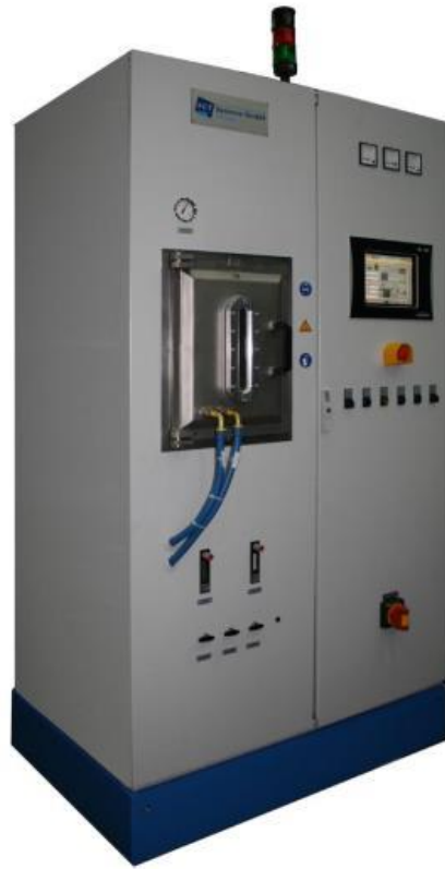
Figura 4-10. Spark Plasma Sintering marca FCT Systeme GmbH HP D 10.
