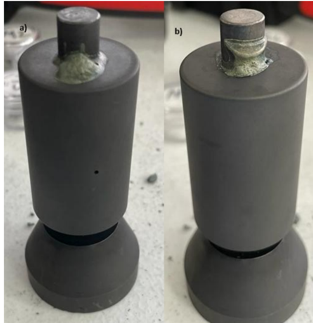
Figura 5-9. a) Muestra M1 y b) muestra M2 sinterizadas a 850°C en matriz con presión.
