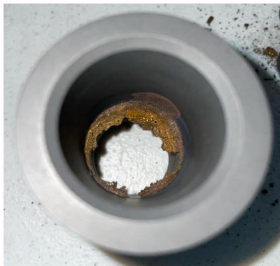
Figura 5-10. Interior de matriz pressureless después de haber sinterizado la muestra M2 a 850°C.
