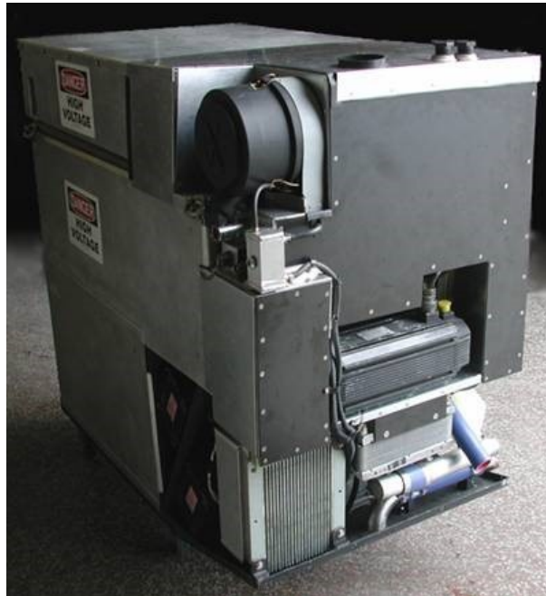
Figura 1.3: Modulo de celdas de combustible de la adaptación del LHD R1300 [7]
