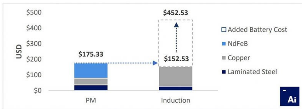
Figura 4.6: Comparativa de costes entre un motor de imanes permanentes y un motor de inducción [10]
