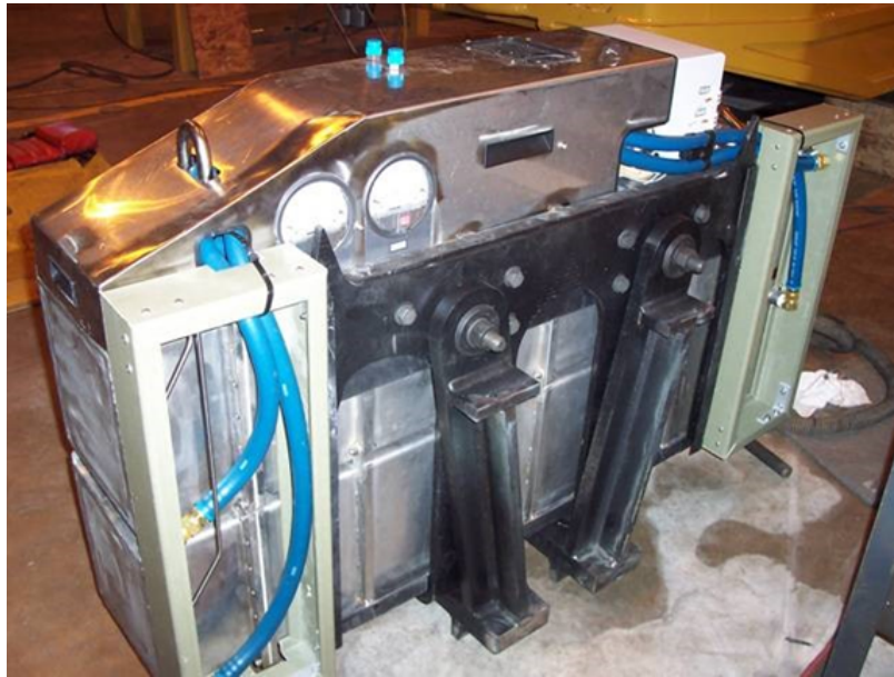
Figura 1.4: Sistema de almacenamiento de hidrógeno marca HERA [7]
