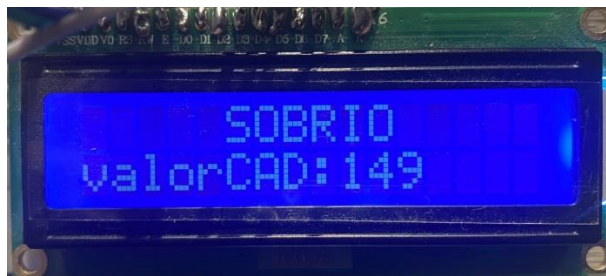
Figura 3-5 Pantalla LCD Display en estado “SOBRIO” del prototipo
