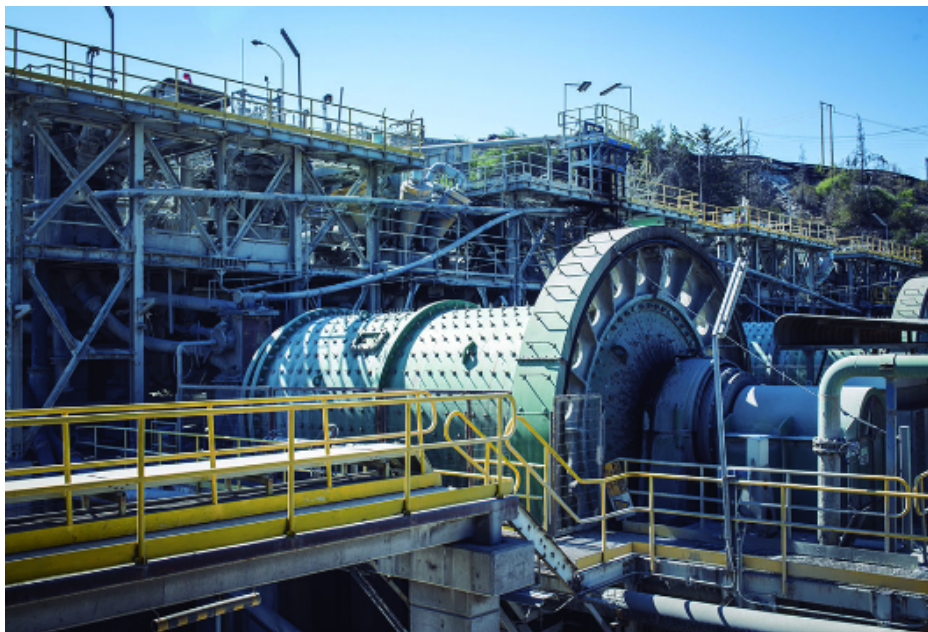
Figura 2.1: Molino de bolas de MVC. Fuente [28]
