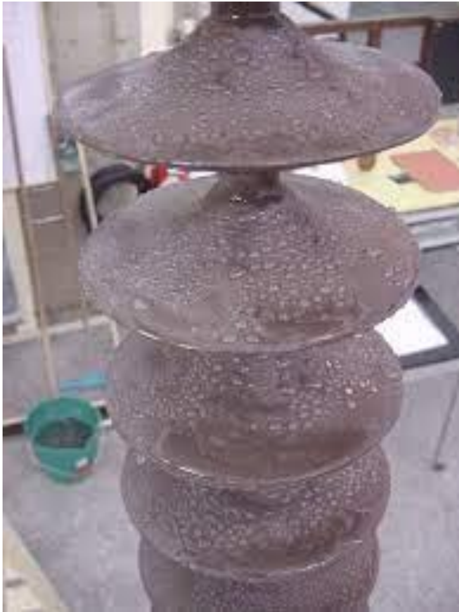
Figura 1-13 Aislador contaminado con polvo y cemento, perteneciente a subestación La Calera
