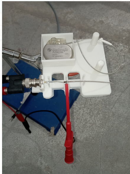
Figura 5.8: Fotografía montura de marcapasos y cable conectados a punta diferencial y pieza adaptadora. Elaboración propia.
