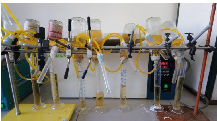
Ilustración 26: Montaje de mini reactores ensayo botella invertida. (Fuente: Elaboración propia)
