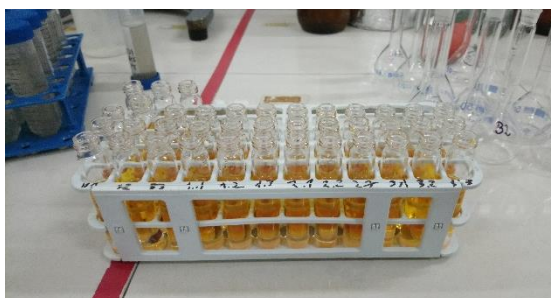
Ilustración 23: Tubos de DQO con las soluciones catalíticas y digestoras y con la muestra de RIL (Fuente: Elaboración propia)
