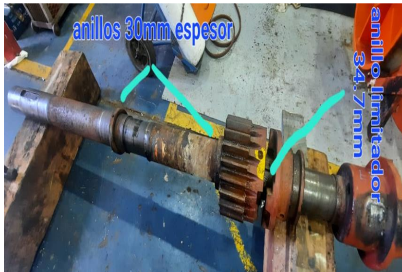
Ilustración 2-16.- Desmontaje del cabrestante parte 3
