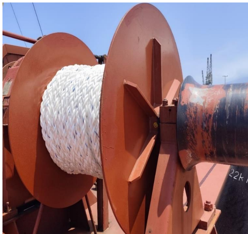
Ilustración 2-8.- Tambor y Cabezal del cabrestante hidráulico
