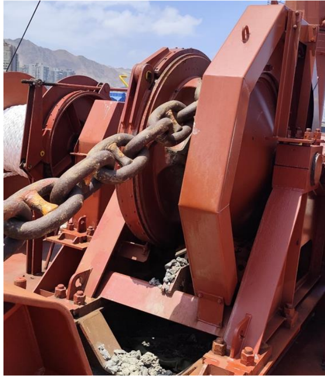
Ilustración 2-7.- Barbontín del Cabrestante hidráulico de anclaje
