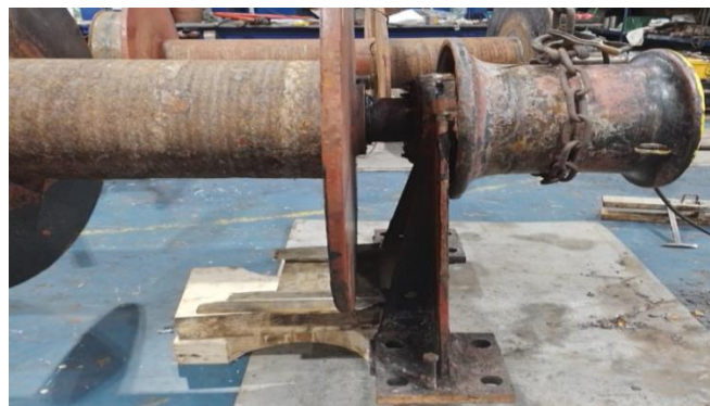
Ilustración 2-14.- Desmontaje del cabrestante parte 1
