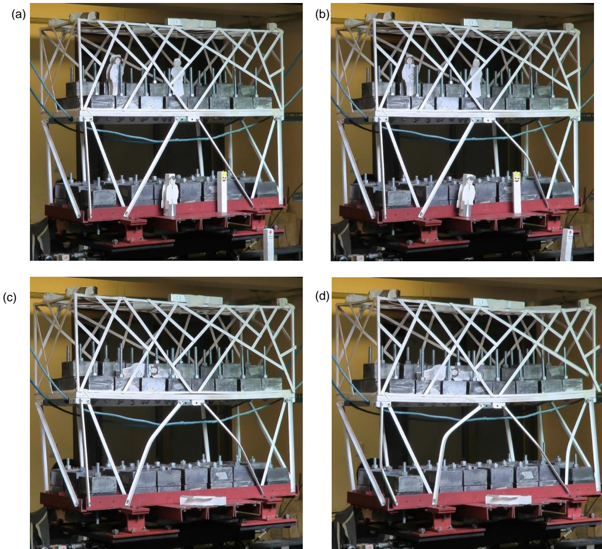
Figura 7-4: Secuencia fotográfica del colapso del modelo tres , luego de ser sometida al registro de viña del Mar de 1985 escalado al 250 %. (a) Comienzo del movimiento basal (b) Nótese que pandea una diagonales. (c) comienza a pandear la diagonal hermana. (d) finalmente pandea la columna, pero no alcanza a colapsar.
