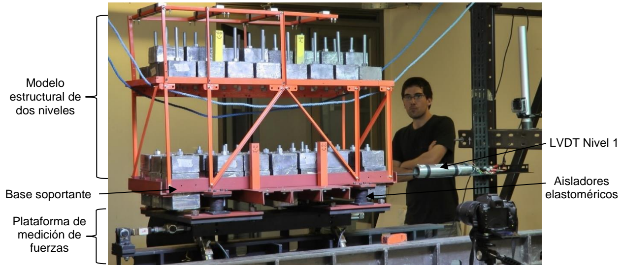
Figura 5-1: Modelo de perfilería metálica escala 1:10, montado en la plataforma de medición instrumentado con transductores de desplazamiento (LVDT), acelerómetros y cámaras. Además, se situaron verticalmente barras de aceros sueltas en varios puntos del modelo, las cuales representan personas.
