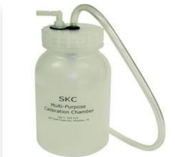
Ilustración 9. Jarra de Calibración utilizada en el estudio
