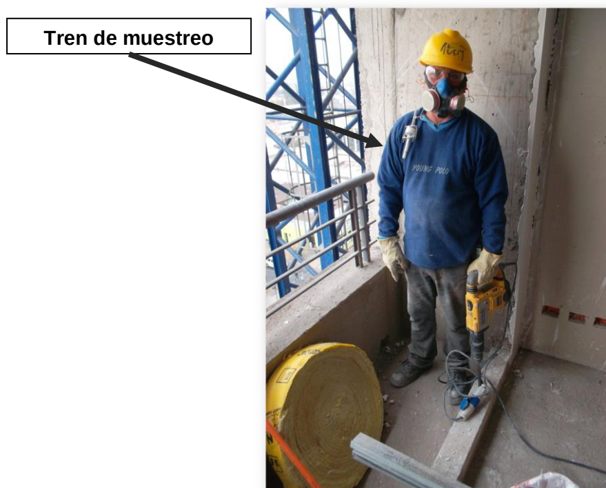
Ilustración 6. Disposición del Tren de Muestreo para Toma de Muestra de Tipo Personal.
