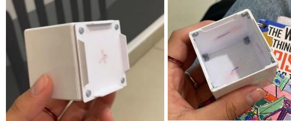
Figura 39 – Forma del bloque y distribución de imanes dentro de cada cara. Elaboración propia.
