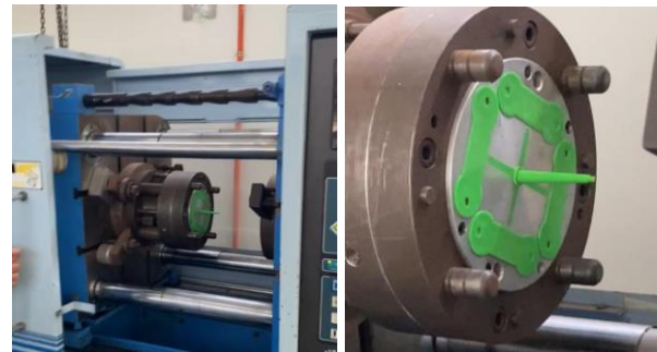
Figura 37 – Molde lleno con plástico, después de la inyección. Elaboración propia.
