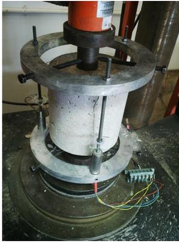
Imagen 5.5) Ensayo BCN Punzonamiento.
