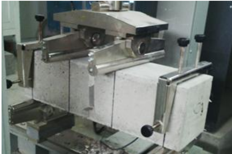
Imagen 3.4). Representación en laboratorio del ensayo ASTM C-1609.
