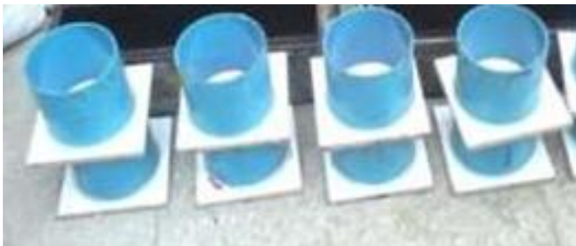
Imagen 3.12) Semicilindros confeccionados con tubos de PVC de 150 \text{ mm} \times 150 \text{ mm} en laboratorio, para probetas BCN.
