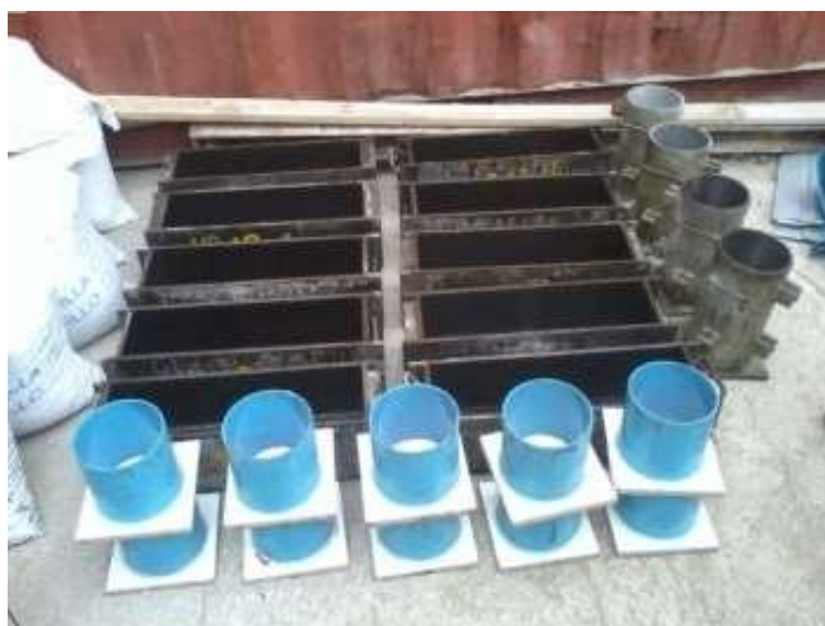
Imagen 4.2). Distribución en terreno de vigas (150 × 150 × 530) mm , vigas (150 × 150 × 600) mm cilindros Compresión (150 × 300) mm y cilindros Barcelona (150 × 150) mm ..
