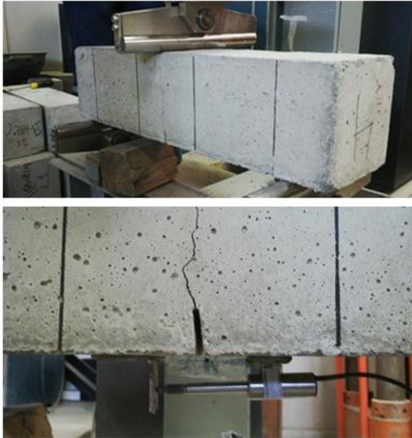
Imagen 3.7). Representación en laboratorio en dos vistas de ensayo EN 14651.
