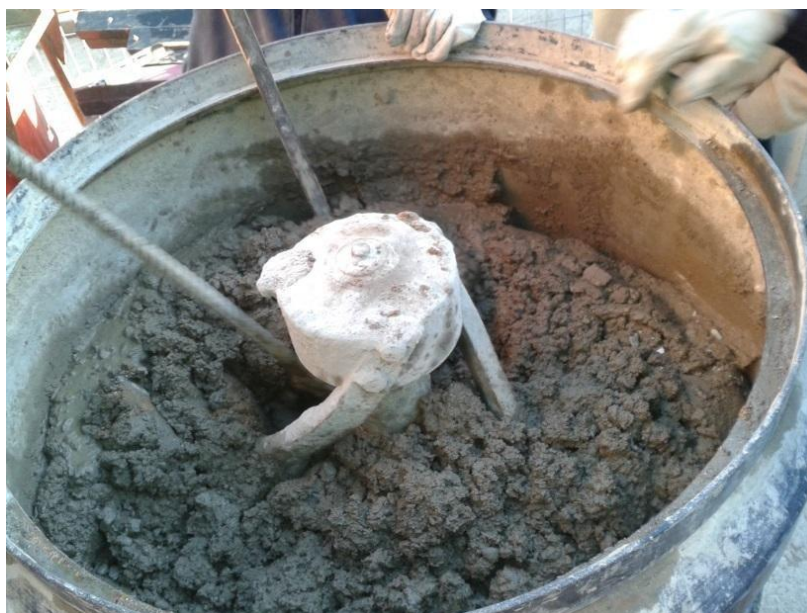
Imagen 4.3). Confección del hormigón en Mezcladora de eje vertical marca Matest® de capacidad 100 lt.
