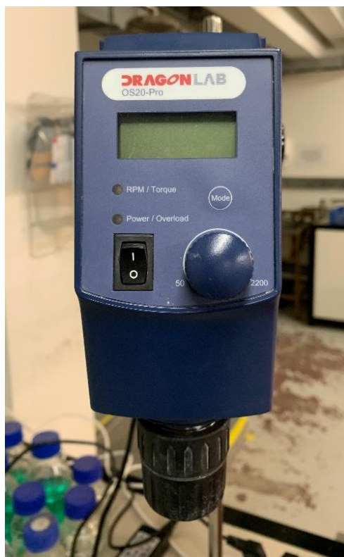
Figura 8.2: Agitador Dragon Lab® OS20-Pro
