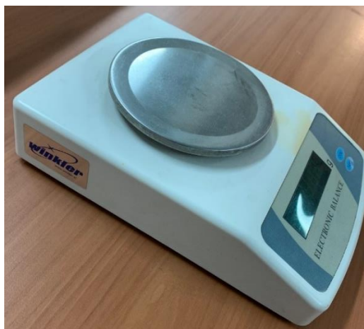
Figura 8.4 Balanza digital Winkler® sensibilidad 0,01[g]
