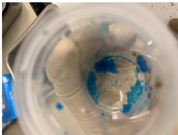
Figura 5.7 Imagen de cristalización de cobre posterior al proceso de decantación de sólidos.
