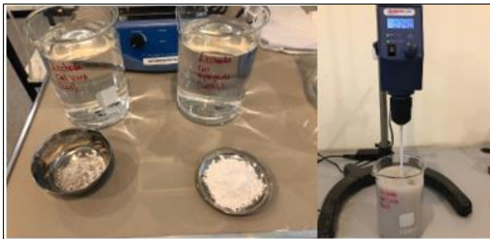
Figura 11 Preparación lechada de cal
