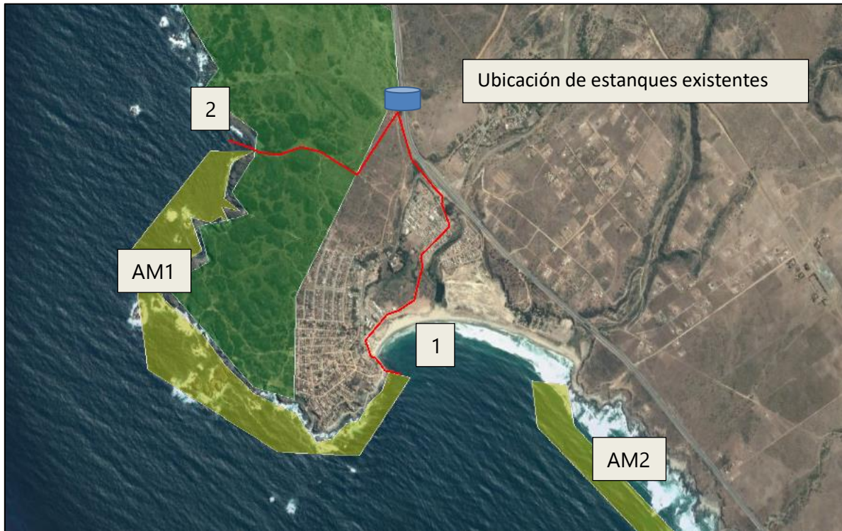
Figura 5.11: Puntos de captación propuestos Alternativa 1.A. (Google Earth).
