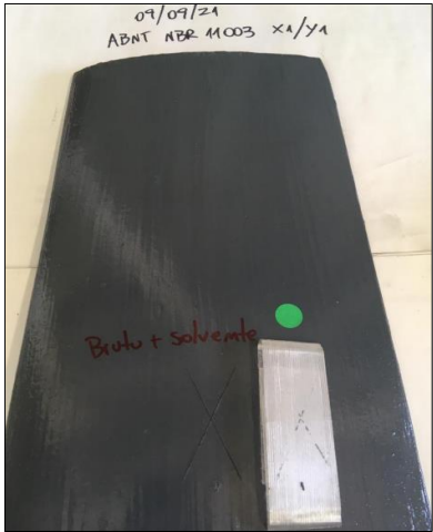
Figura 3-18. Resultado: Ensayo de adherencia aprobado.
