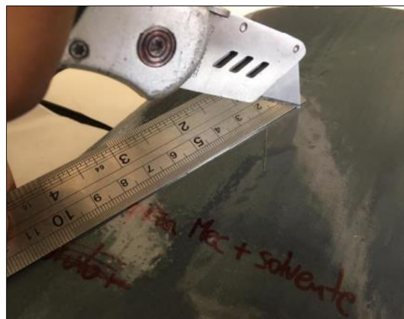
Figura 3-15. Paso 1: Ensayo de adherencia. Fuente: Taller de Howden.
