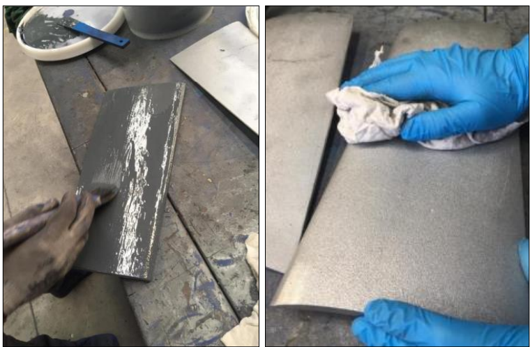
Figura 3-5. Limpieza y tratado del álabe. Fuente: Especificaciones del revestimiento “ARC 855”.
