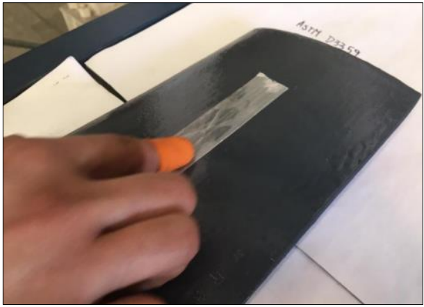
Figura 3-16. Paso 2: Ensayo de adherencia. Fuente: Howden Chile spa.
