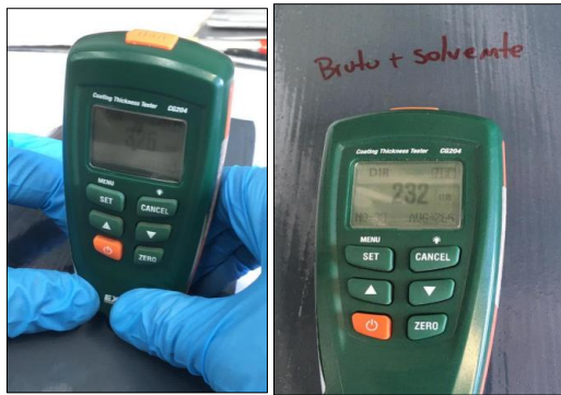
Figura 3-14. Control de micras. Fuente: Toma de datos Howden.
