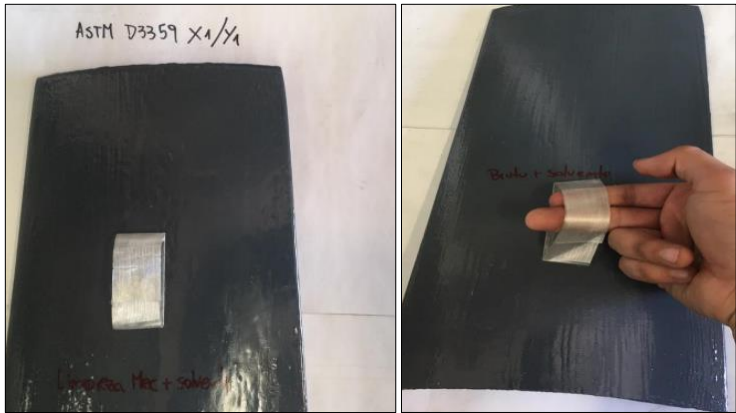
Figura 3-17. Paso 3: Ensayo de adherencia. Fuente: Howden Chile spa.
