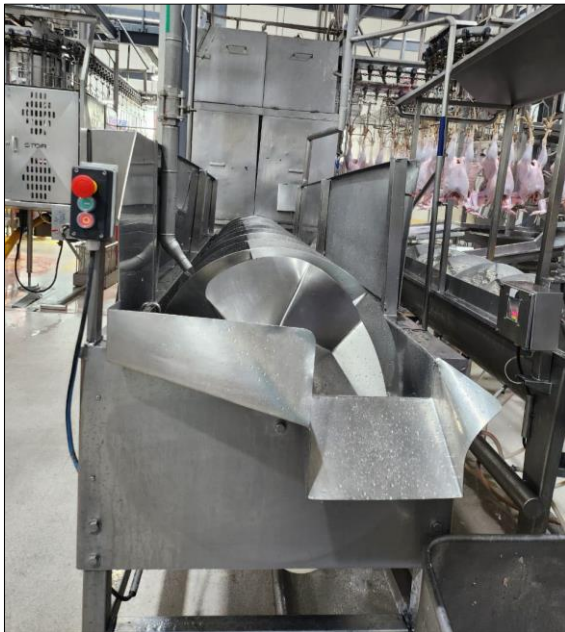
Figura 3.2. Equipo chiller en desuso
