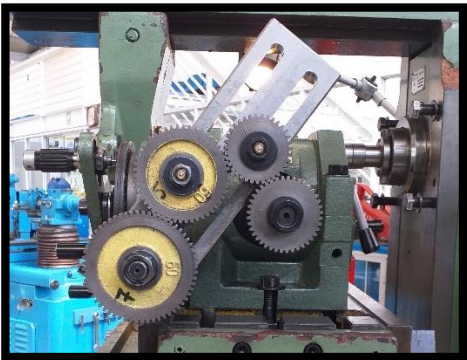
Figura 2- 1: Montaje de ruedas con uso de lira. Fuente: Elaboración propia.
