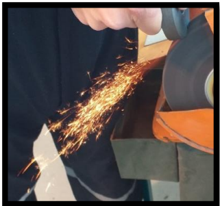
Figura 1-29: Ensayo de chispa. Fuente: Elaboración propia.
