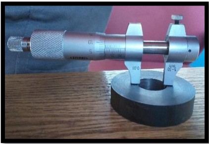
Figura 2- 3: Micrómetro de interior para la medición del agujero de la rueda. Fuente: Elaboración propia.
