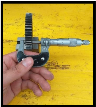
Figura 2- 2: Micrómetro de exterior para la medición del ancho o espesor de la rueda. Fuente: Elaboración propia.
