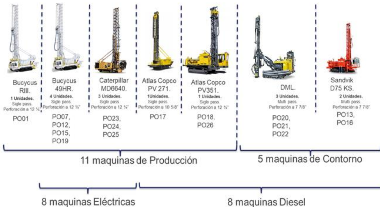
Ilustración 4: Flota de perforación de CMDIC, donde se muestra los equipos de producción y contorno. Fuente: Informe gestión de perforadora diciembre 2020.
