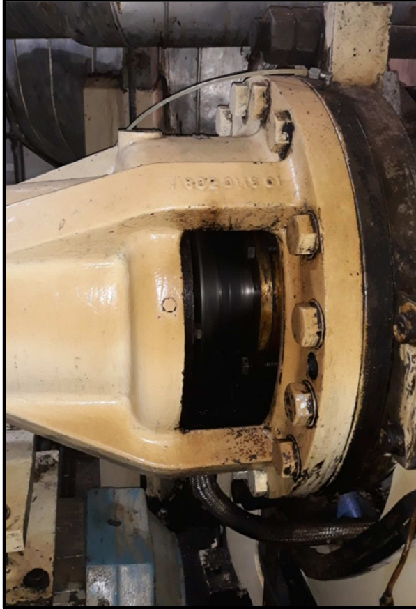
Figura 2-42.: Fotografía punto de lubricación Tornillo alimentación Desfibrador.
