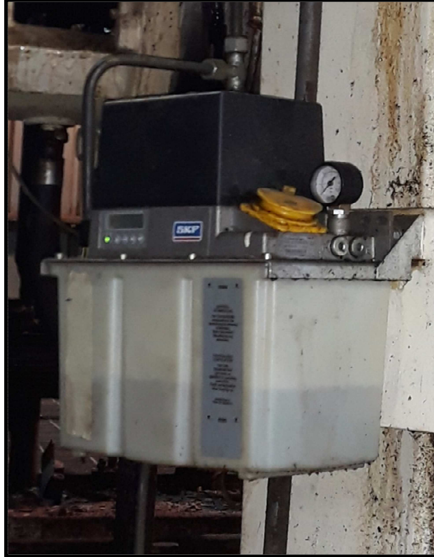
Figura 2-38.: Fotografía Lubricador automático SKF.
