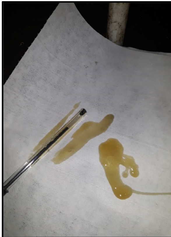
Figura 2-70.: Fotografía donde se aprecia que el líquido que tiene el filtro es aceite.
