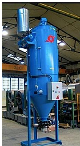
Ilustración 3: Colector de polvo por vía seca
