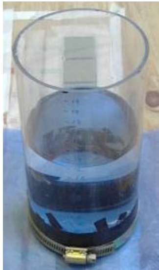
Fig. 3.8.- Cilindro de calibración lleno con agua.
