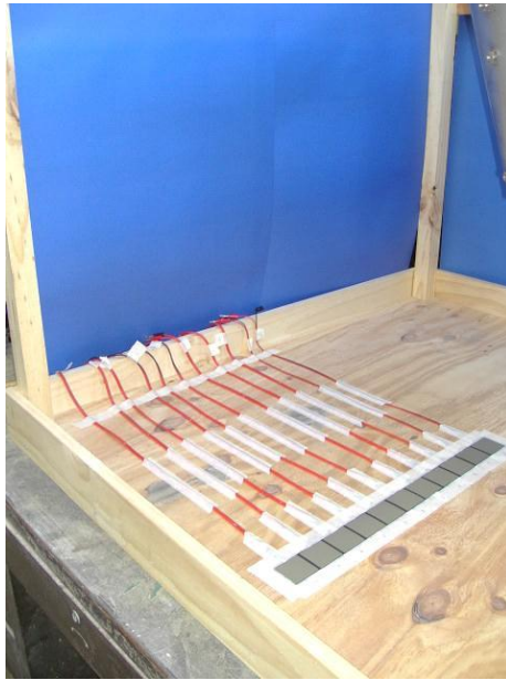
Fig. 3.7.- Disposición de los sensores en la base del modelo.
