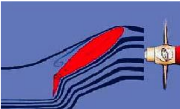
Figura 3-9. Acción del timón con flap bajo la incidencia del agua. Fuente: Análisis operacional del sistema hidráulico de gobierno de un remolcador de puerto de 20 TM BP, autor: Augusto Elmer Cabello López. Lima, Perú, 2011.
