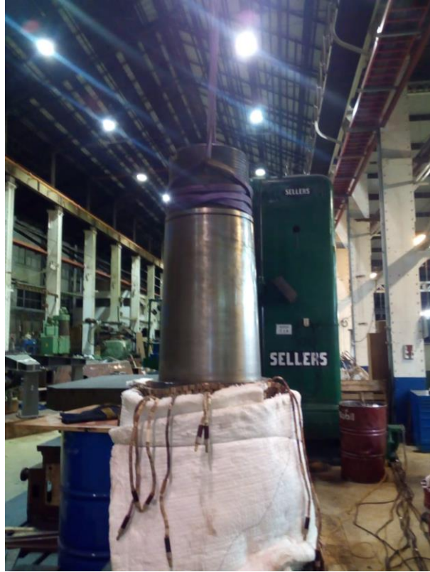
Figura 4-21. Montaje de bocina metálica en Pinzote por medio de dilatación térmica.
