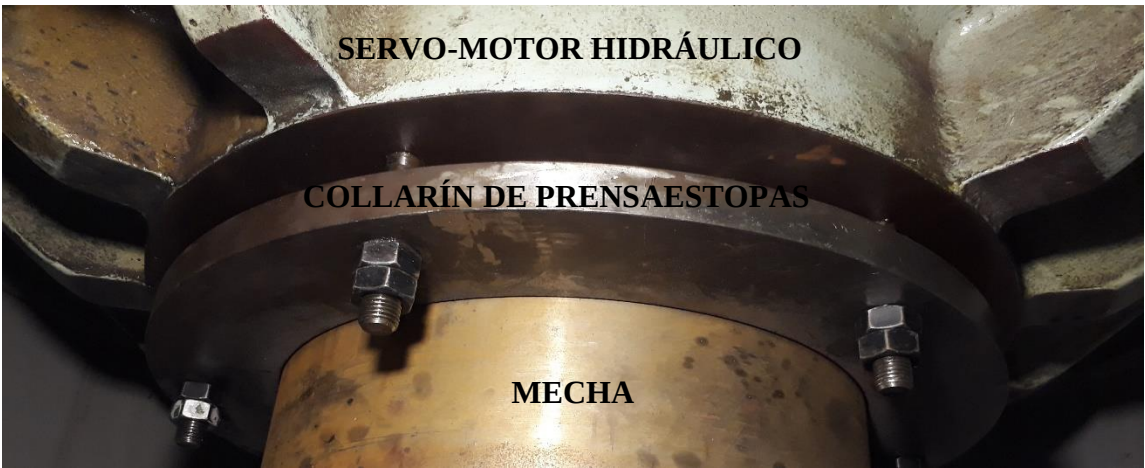
Figura 4-18. Fotografía de la prensaestopas debajo del servo-motor hidráulico. Fuente: Tomada en práctica profesional, 2019.
