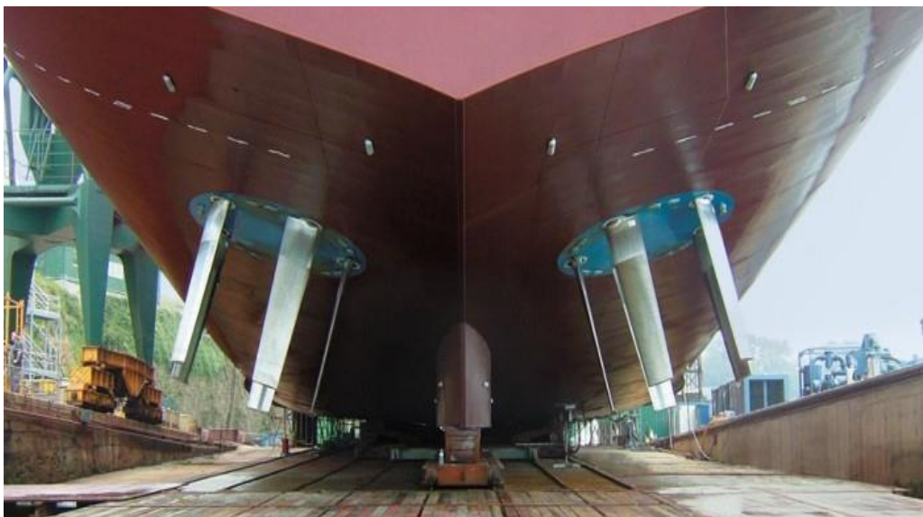
Figura 3-17. Sistema Voith propeller instalado en la embarcación.
