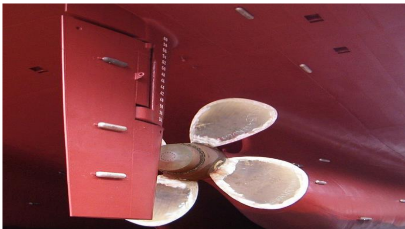
Figura 3-14. Timón tipo semi-pala instalado en un buque.
