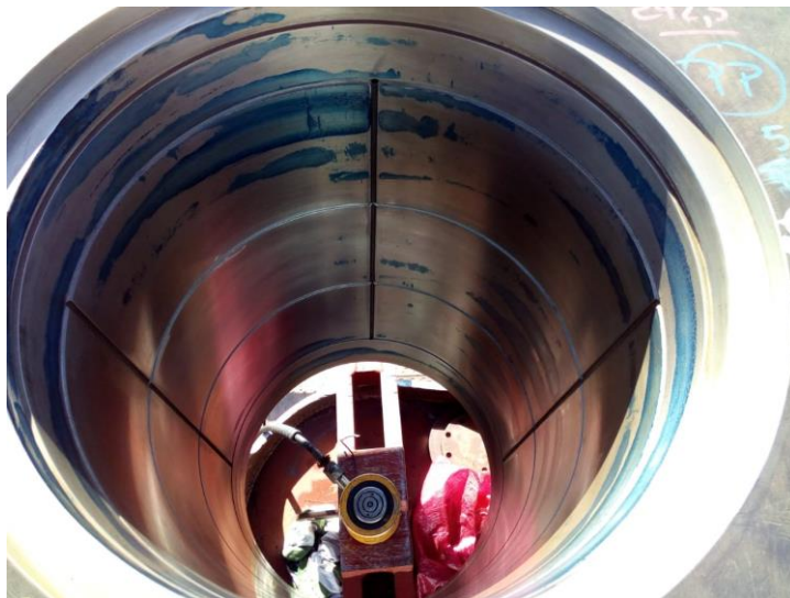
Figura 4-26. Marcas del azul de Prusia en el cono interior del timón.
