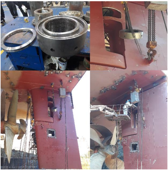
Figura 4-32. Montaje de tuerca pistón en el roscado inferior de la Mecha. Fuente: Fotografía adquirida en práctica profesional, 2019.
