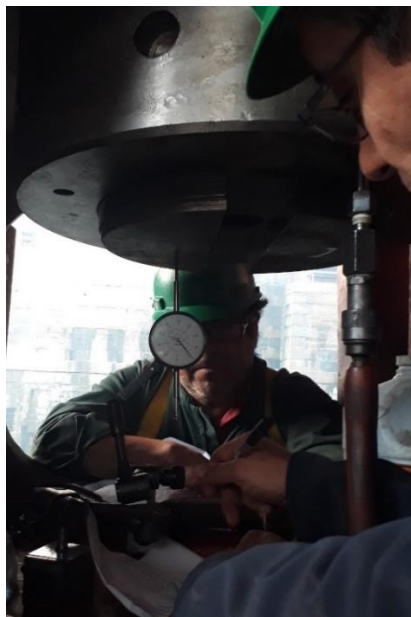
Figura 4-33. Medición del desplazamiento del calado de conos mediante un reloj comparador.
