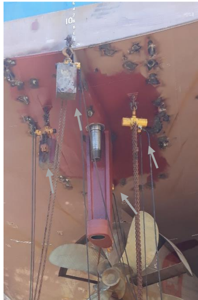
Figura 4-30. Tecles neumáticos preparados para montar el timón.
