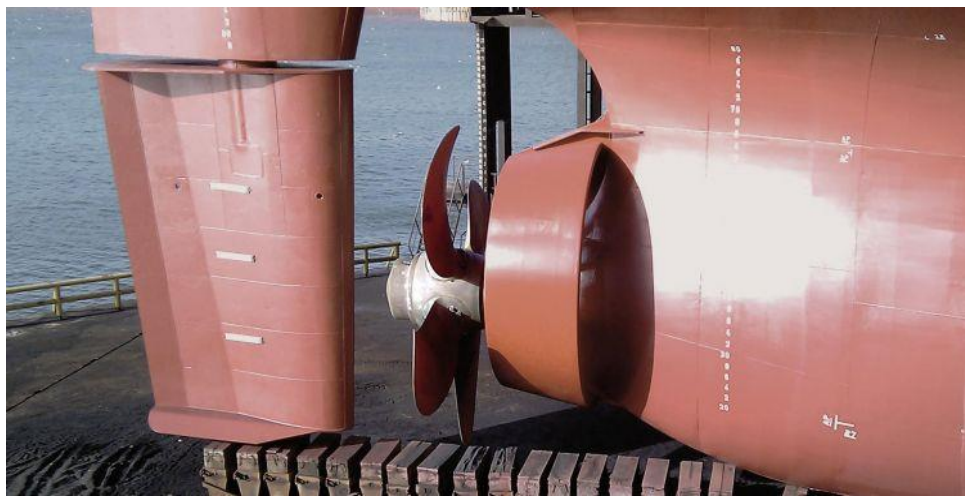
Figura 3-12. Timón Schilling montado en la motonave.
