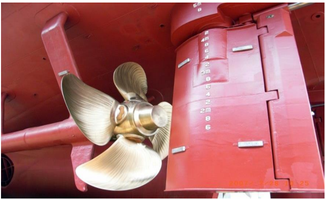
Figura 3-8. Pala de timón tipo flap 2019. Fuente: Catálogo ZHIYOU marine & offshore equipment supplier.
