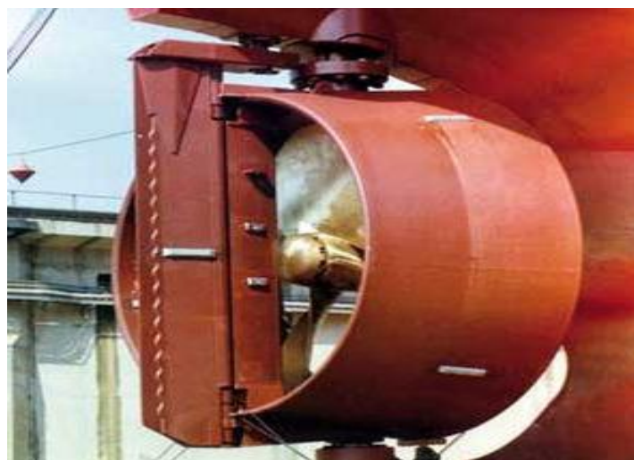
Figura 3-15. Timón integrado a una tobera instalada popa de un buque.
