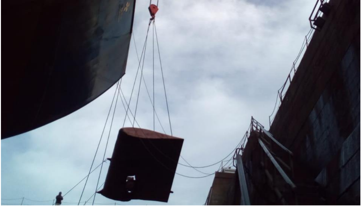
Figura 4-14. Maniobra de retiro del conjunto timón.
