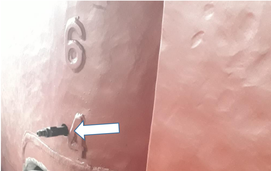
Figura 4-11. Niple hidráulico conectado a la cámara de expansión de macizo superior del timón.
