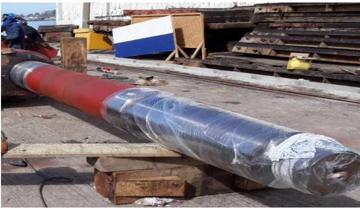
Figura 3-19. Mecha montada en la pala timón de la embarcación mercante. Fuente: Foto tomada en práctica profesional 2019.
