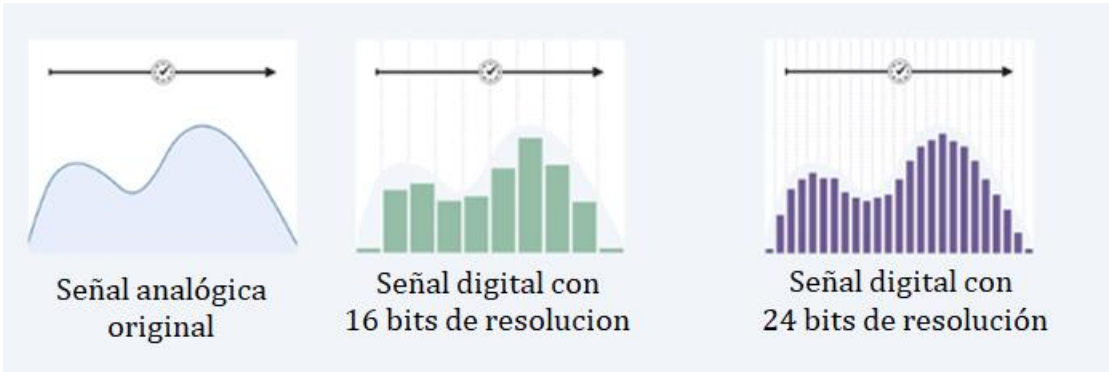
Figura 4-68 Comparación de señal analógica vs señales digitales con diferente resolución.
