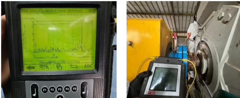
Figura 4.6 Verificación de alineamiento y análisis de vibraciones.
