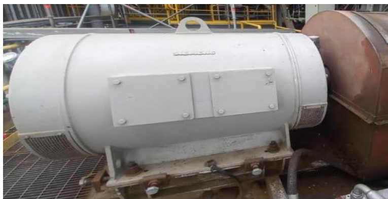
Figura 3.4 Motor eléctrico 800 KW.
