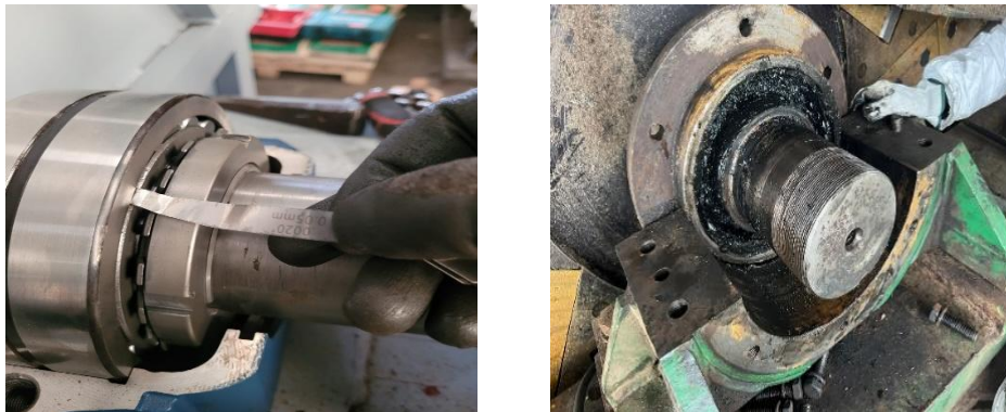
Fuente: Comaco Pto. Montt Figura 4.8 Cambio de rodamientos
