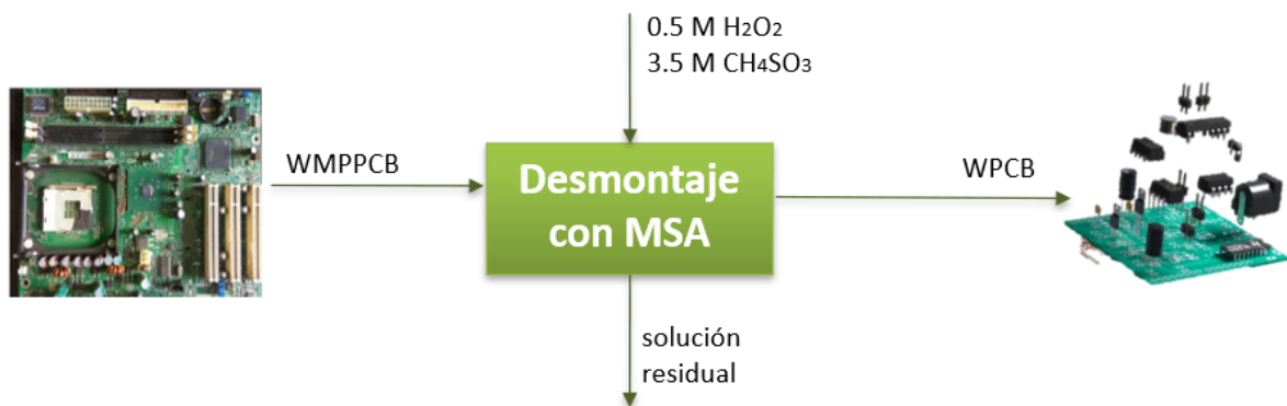
Figura 11: Desmontaje químico del WMPPCB con \text{CH}_4\text{SO}_3 y \text{H}_2\text{O}_2
