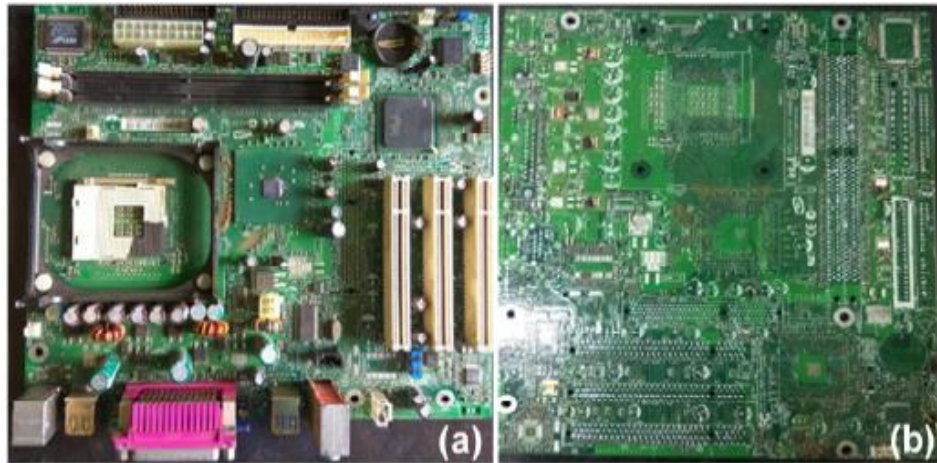
Figura 9: WPCB de computador a) antes y b) después del desmontaje de los EC. [56]
