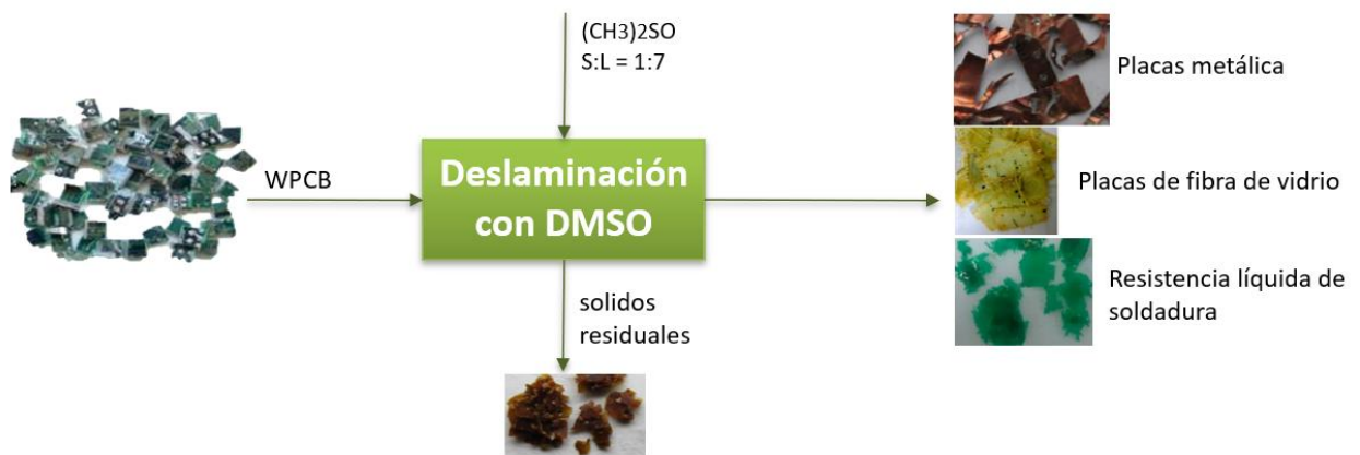
Figura 13: Deslaminación de la MPPCB con DMSO
