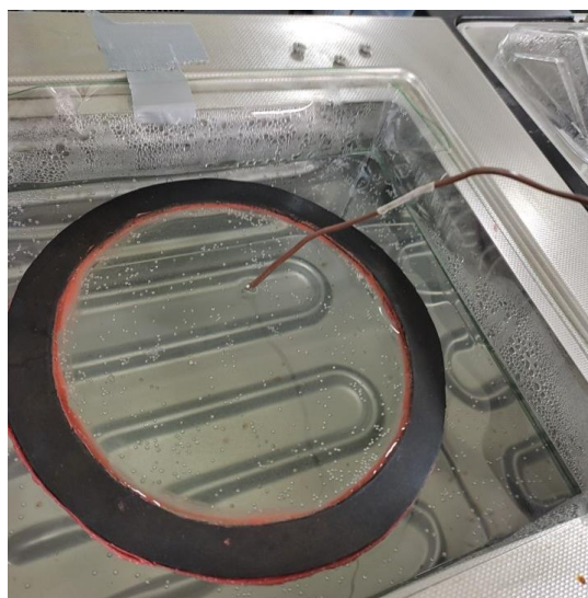
Figura 9. Instalación Experimental Secado en Ventana Refractaria.
