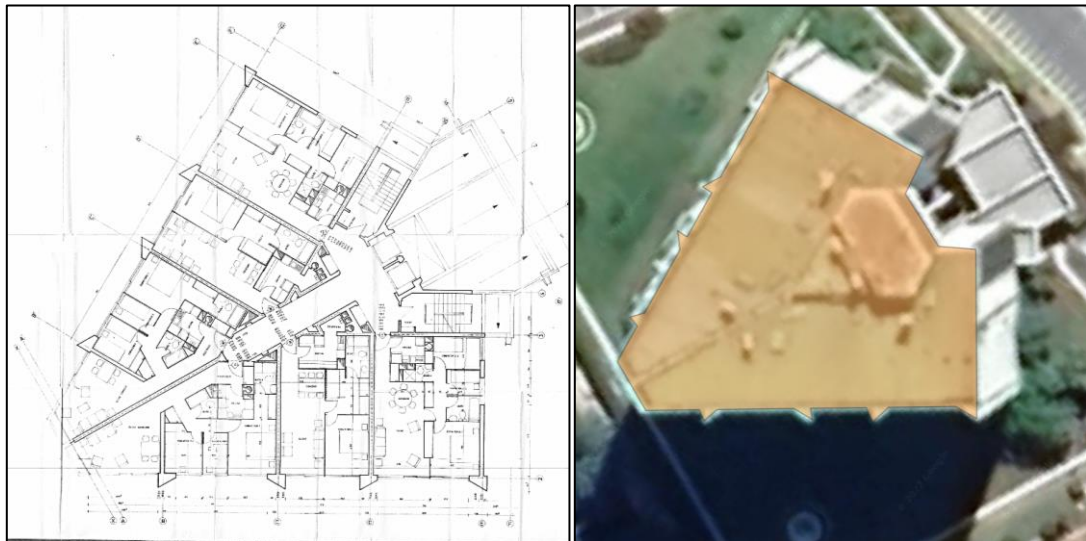
Figura 18: Estimación de áreas, polígonos y ubicación de la planta a nivel de suelo de los edificios a partir de herramientas SIG
