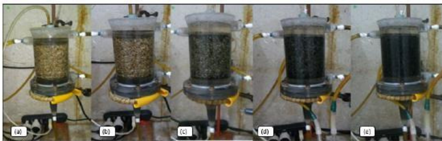
Figura 17 Proceso de formación de biopelícula. Enriquecimiento del reactor UAF en operación fed batch , inóculo (a): día 1-5, acondicionamiento de la superficie (b): día 6-11, adherencia a la superficie (c): día 11-16, maduración de la biopelícula (d): día 17-24, desprendimiento de las bacterias en el relleno (e): día 25-35.
