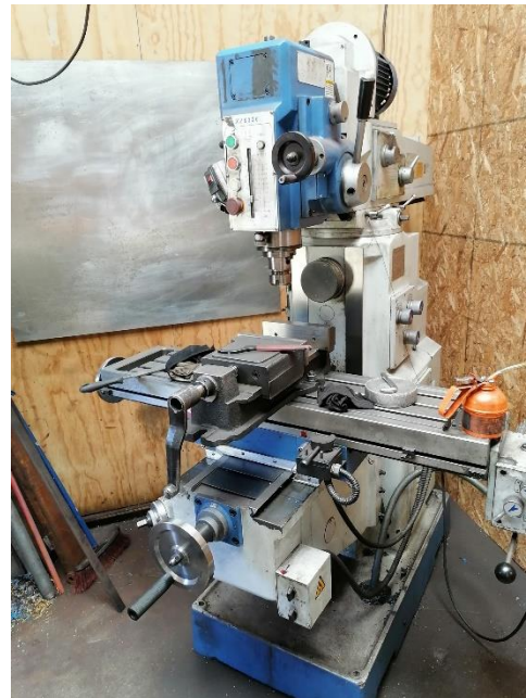
Figura 1-12 Fresadora secundaria Fuente: Taller Veproind
