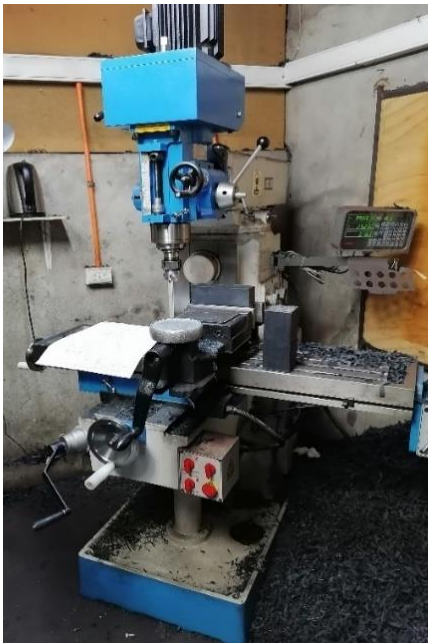
Figura 1-11 Fresadora Principal Fuente: Taller Veproind
