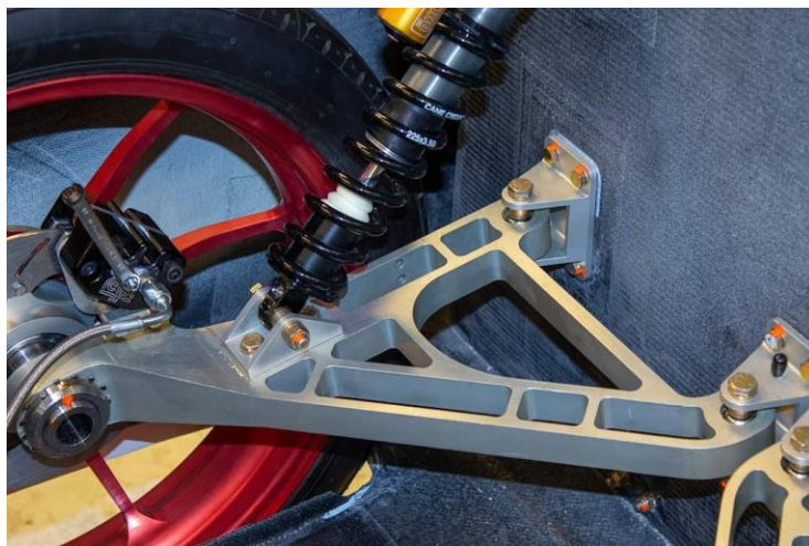
Figura 1.5: Suspensión “trailing arm” de Blue Sky Solar Team.
