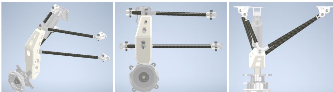
Imagen 10.1: Diseño final generado para el diseño de la suspensión del nuevo auto Ergón 3 del equipo de la USM.
