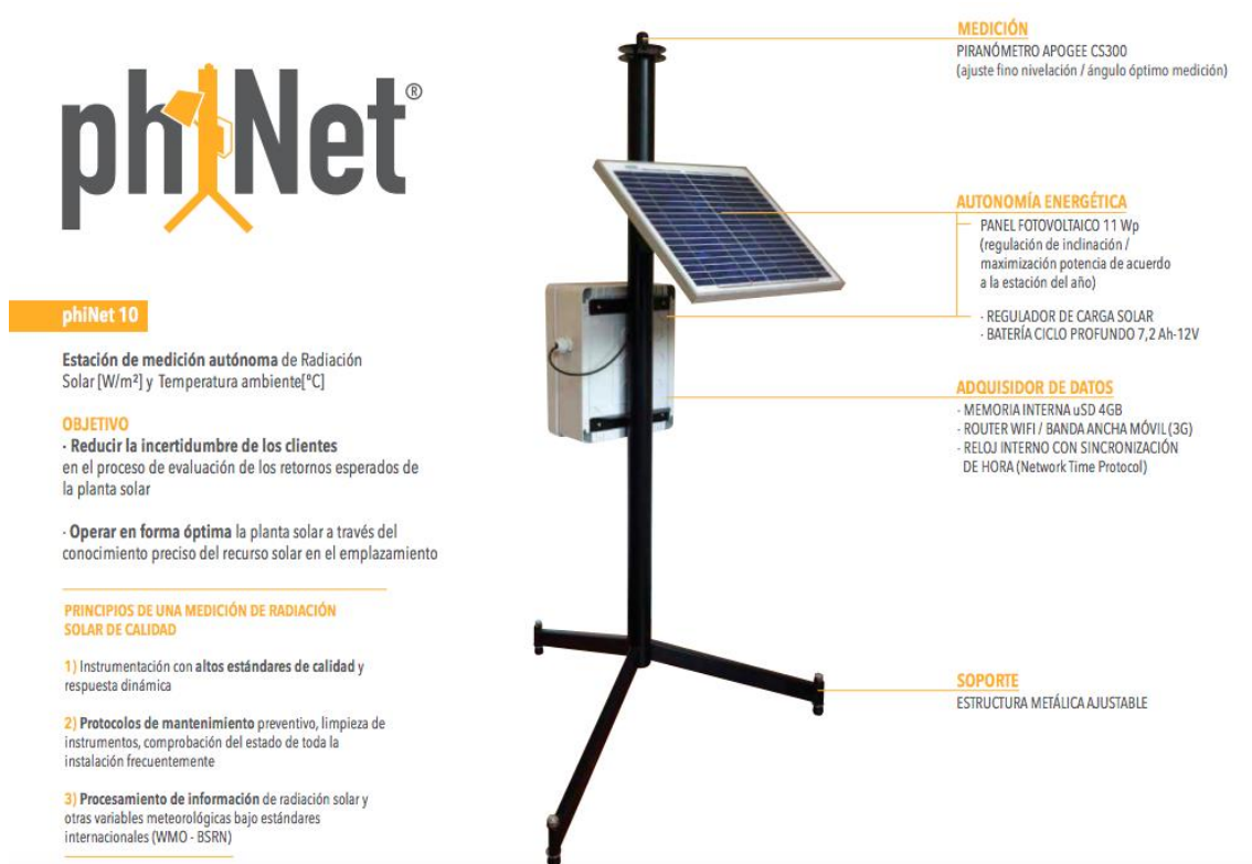
Figura 20: Componentes instrumentación medición irradiación solar.
