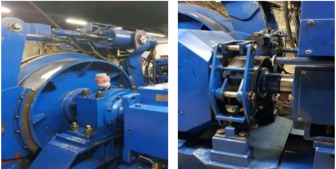
Figura 2. Freno principal y freno másico
