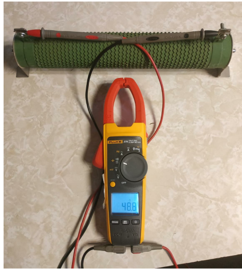
Figura 4.2: Medición de resistencia de 48.8 \Omega
