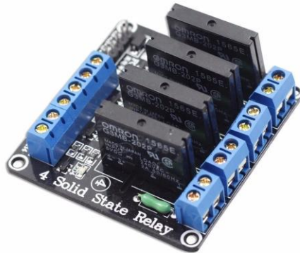
Figura 7-1 Relés de estado solido
