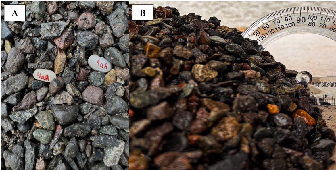
Ilustración 25: A corresponde a marcadores 4aA (0,0,45) y 1aA (0,0,0), por otro lado la B corresponde al ángulo de talud natural. Elaboración propia.
