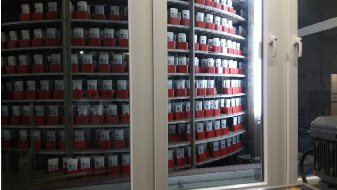
Figura 3.17: Torre de enfriamiento de la línea de envasado Deostick.
