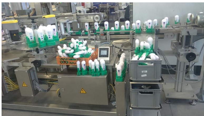
Figura 3.31: Acumulación de productos buenos por mal ajuste de la cámara.
