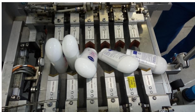
Figura 3.30: Caída de envases en equipo enfardador
