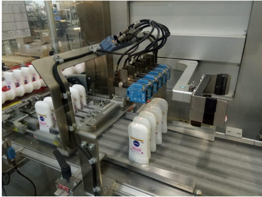
Figura 3.19: Proceso de pre-empacado.
