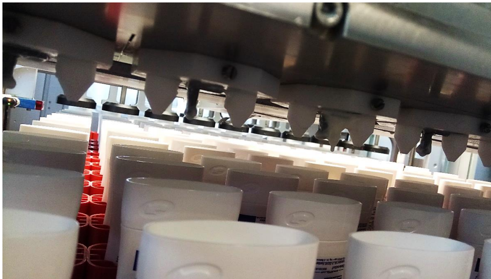
Figura 3.16: Posición del envase dentro de la máquina de llenado.
