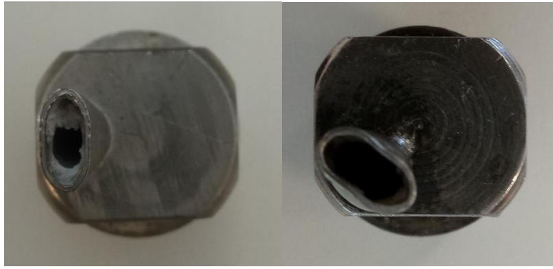
Figura 5.12: Boquillas actuales para formato Neruda (izquierda) y formato Barra Libre (derecha).
