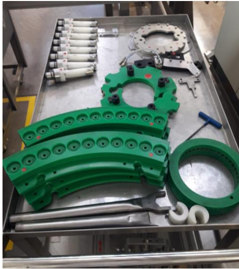
Figura 5.24: Componentes del equipo tapador después del orden en el carro de cambio de formato.
