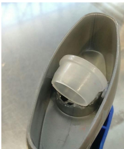
Figura 3.27: Inserto mal colocado en envase Barra Libre Masculino
