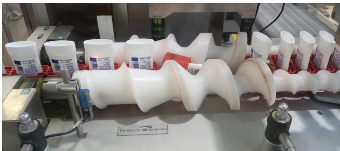
Figura 5.7: Porta-envase atorado en el tornillo de alimentación provocando la deformación de este.
