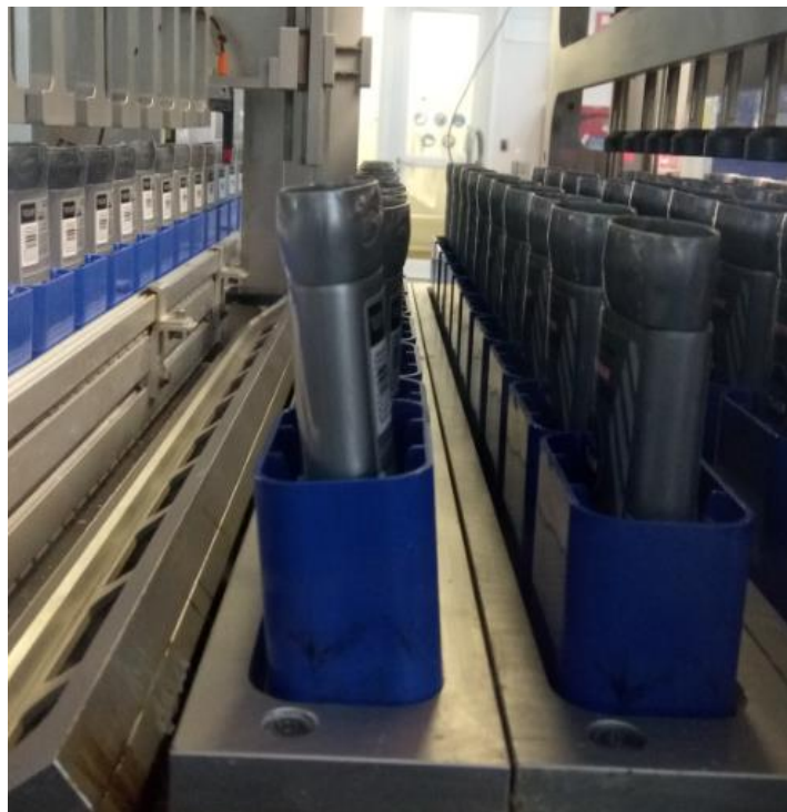
Figura 4.10: Desviación de porta-envase al entrar a la máquina.
