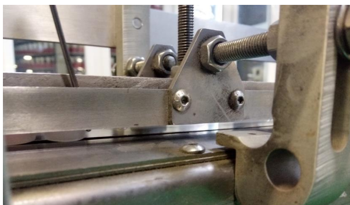
Figura 3.28: Inserto atrapado en la guía en la mitad del recorrido
