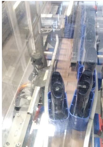
Figura 3.24: Porta-envase escapando de la línea cerrada del conmutador.
