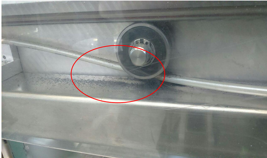
Figura 3.22: Polvo dentro de la sección de la correa superior de la etiquetadora.
